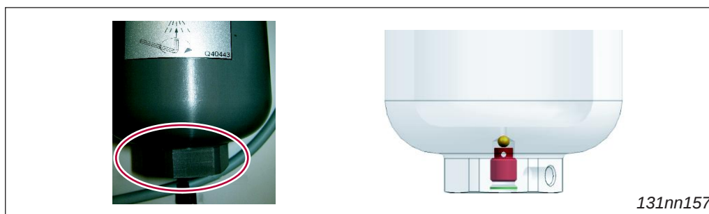
图3-36 带有冷凝水排出的过滤器单元
